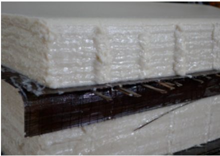
Fig. 10. Porce sans intercalaire après pressée. Papier Xuan, Red star, Hong Xuing, Jingxiang, Anhui Chine © J. Bréjoux
