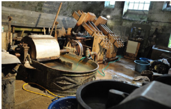
Fig. 8. Au premier plan un cylindre hollandais de laboratoire Lamhort 1937. Au deuxième plan un cylindre hollandais du dernier tiers du XIX e siècle. Au troisième plan deux creux de pile à maillets, 2007 © Gérard Martron
